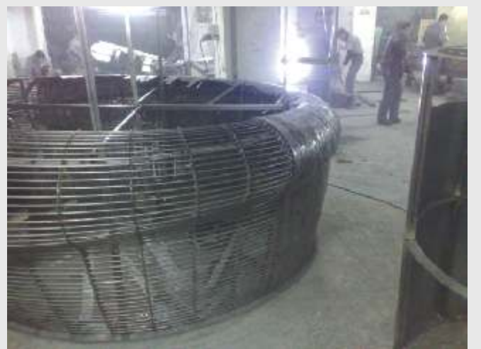
AKRİLİK BANKO VE KOLON KAPLAMALARIN İÇ KONSTRÜKSİYONLARI VE PASLANMAZ ÇELİK İMALATLARI
